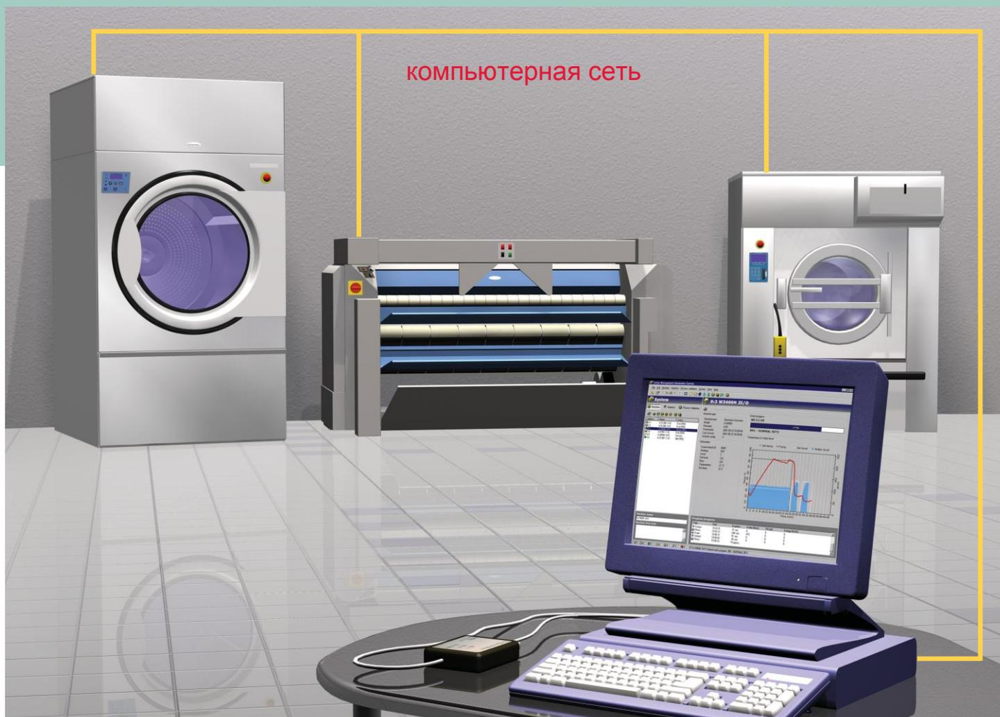
CMIS может быть установлен на любую стиральную машину Electrolux оснащенную Clarus Control, на сушилки с Selecta контроль и гладильные машины серии IC350\* и IC448\*. Все, что вам нужно для получения доступа и просмотра статистики это персональный компьютер.
